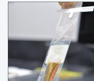
Para evitar fugas de líquido, apriete el líquido de la parte superior de la bolsa hacia abajo e introduzcalo en la cámara inferior. Corte la parte superior de plástico por encima del cierre blanco.
