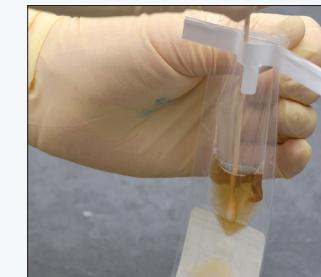
Para introducir el hisopo, abra la bolsa tirando de las lengüetas centrales de la cinta de cierre. Apriete con cuidado una pequeña cantidad de líquido en la cámara superior y pase el hisopo entre las paredes de la bolsa. Retire el hisopo y desechealo.
